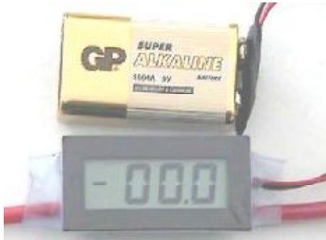
Das Bord-Ampere-meter ist ein 3½stelliges LCD-Paneelmeter das Sie zum Messen in das Modell legen können, bei größeren Modellen und Hubschraubern kann es auch dauerhaft eingebaut werden. Mit dem Digital-Bord-
